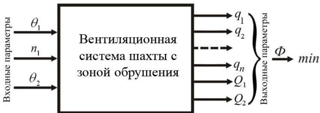
$\theta_1, \theta_2$ , – углы установок лопаток направляющих аппаратов вентиляторов, град;  $n_1$  – частота вращения рабочего колеса первого вентилятора, об/с;  $q_1, q_2, \dots, q_n$  – расходы воздуха по подземным потребителям,  $\text{м}^3/\text{с}$ ;  $n$  – количество подземных потребителей;  $Q_1, Q_2$  – подача первого и второго вентилятора соответственно,  $\text{м}^3/\text{с}$ ;  $\Phi$  – критерий оптимизации (функция цели решаемой задачи)
